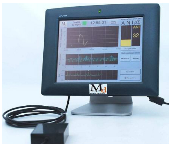
Figura 1 Monitor Physiodoloris. Janela inferior: sinal de ECG. Janela intermediária: Frequência respiratória normalizada, centrada na média e filtrada. Janela superior: curva de tendência ANI.
